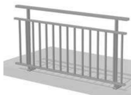
Barreaudage sous lisse intermédiaire
